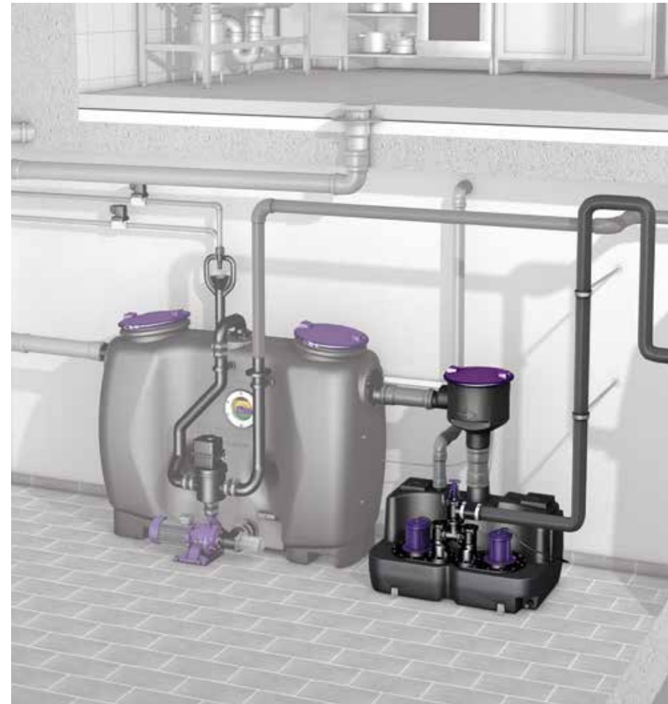
Voorbeeld van een stroomafwaarts geplaatste KESSEL-opvoerinstallatie
